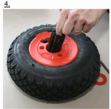
Mit einem Schraubendreher den kleinen Deckel am Rad herauslösen, danach kann das Rollenlager entnommen werden. Das Lager nun mit Wasser abspülen ebenso dasRad selbst. Nicht einfetten oder einölen!!
