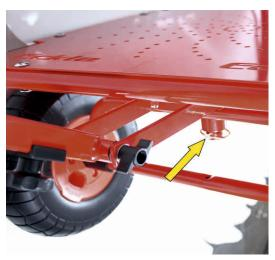
Nachdem Sie die Lenkung aufgesteckt haben bitte mit dem Klappsplint sichern. After you have put on the steering please secure it with the linch pin.
